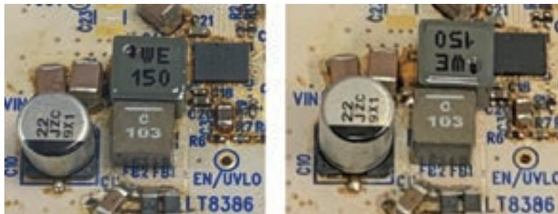
图11. 采用DC3008A LT8386 LED驱动器的Würth 74439346150(“WE 150”)电感方向辐射测试。L1方向1(左), 绕组的短端子起始点在SW节点上; L1方向2(右), 长端子在SW节点上。辐射结果如图12所示, 表明绕组起始点应连接到SW节点以获得最佳效果。
