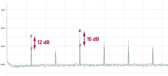
图6. 电磁辐射干扰, V_{IN} = 12\text{ V} , I_{LOAD} = 50\text{ mA} , C_{FLY} = C_{OUT} = 2.2\text{ }\mu\text{F} , f_{SYNC} = 500\text{ kHz} 。绿色 = 标准, 蓝色 = IICP。
