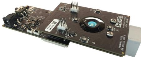
图16. ADI的96TOF光学深度测量电路板。
