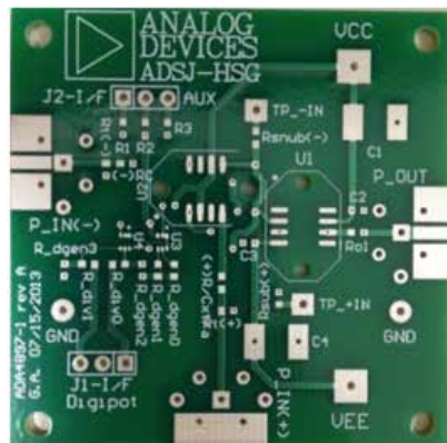
图6. 放大器评估板，包含数字电位计连接
