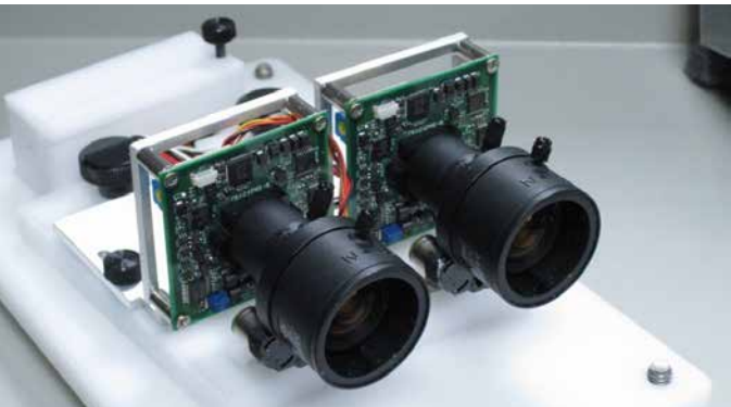
图1. 支架上的两台摄像机(已针对立体视觉对齐)
