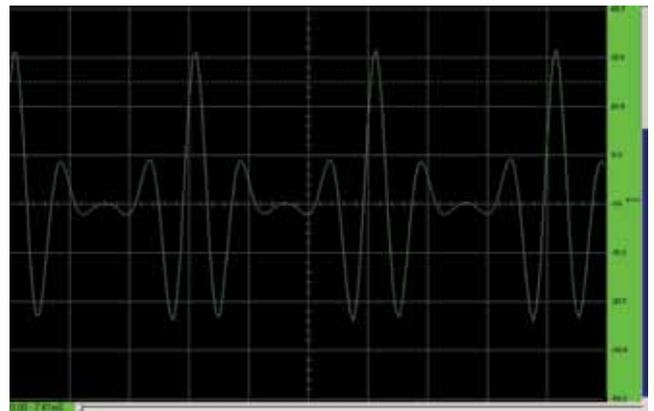
图3. 以1 MHz频率重复的4 MHz高斯正弦脉冲
