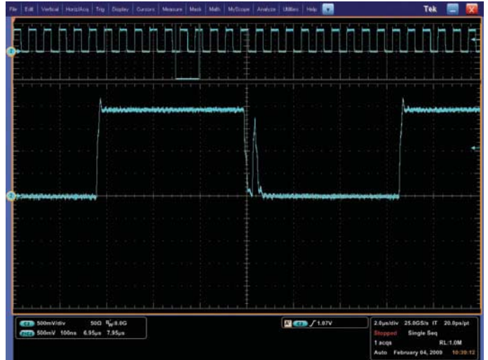
图48. 采样率越高，信号分辨率越好，保证您将看到间歇性事件。
