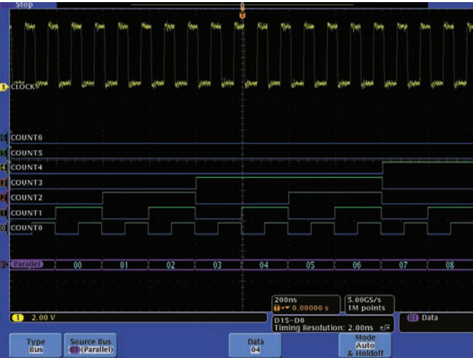
图56. 自动触发、解码和搜索时钟输入或非时钟输入并行总线数据。
