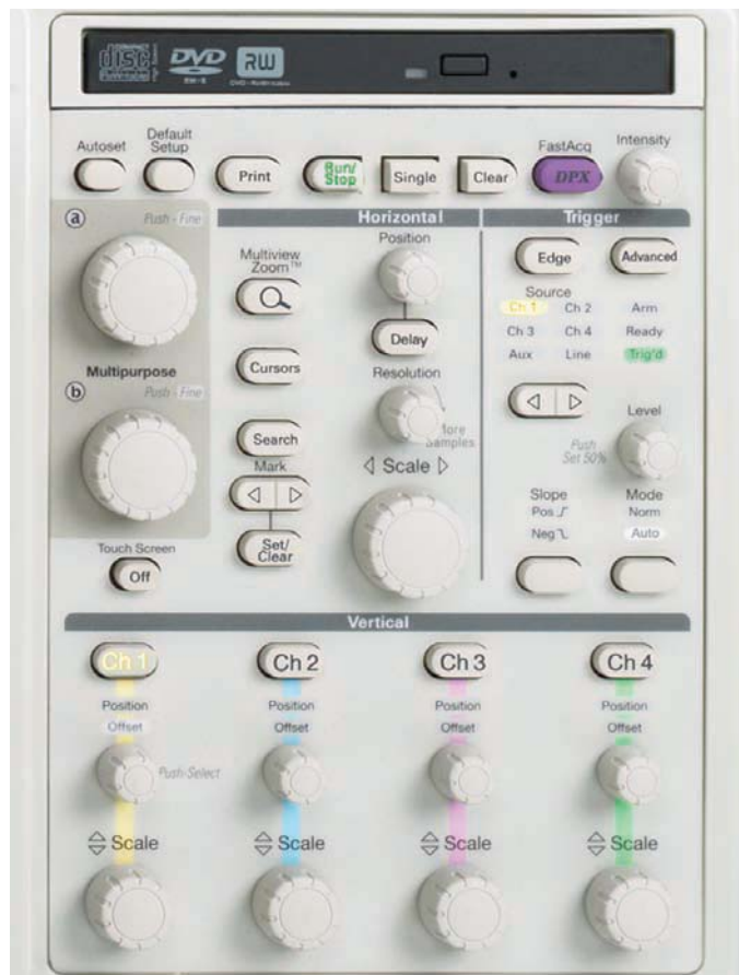
图20. 示波器的前面板控制功能区域。
