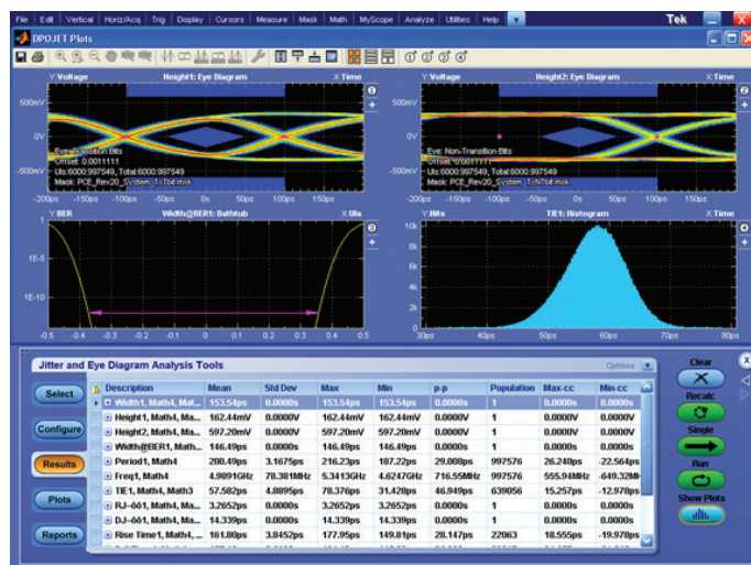
图54. 分析软件包是为满足当前高速数字设计人员的抖动和眼图测量需求专门设计的。
