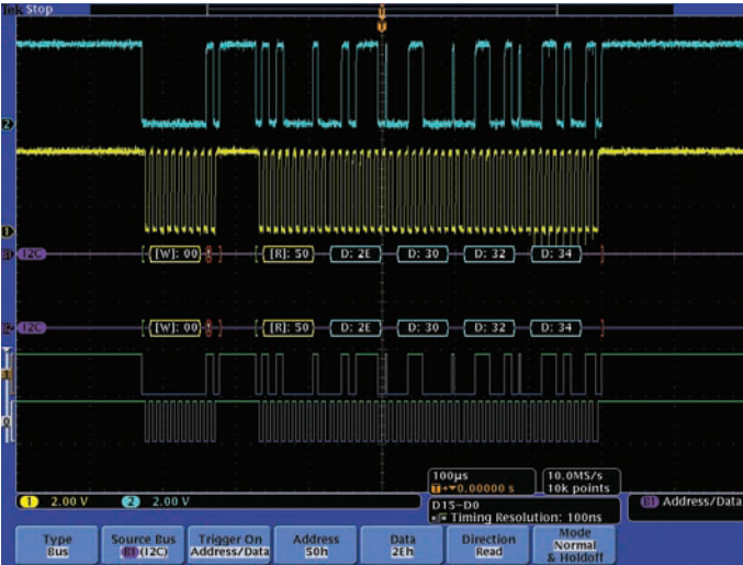
图55. 自动触发、解码和搜索串行数据包上下文加快了串行总线分析速度。
