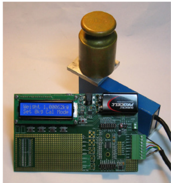
图2.采用AD7195 的电子秤系统设置
