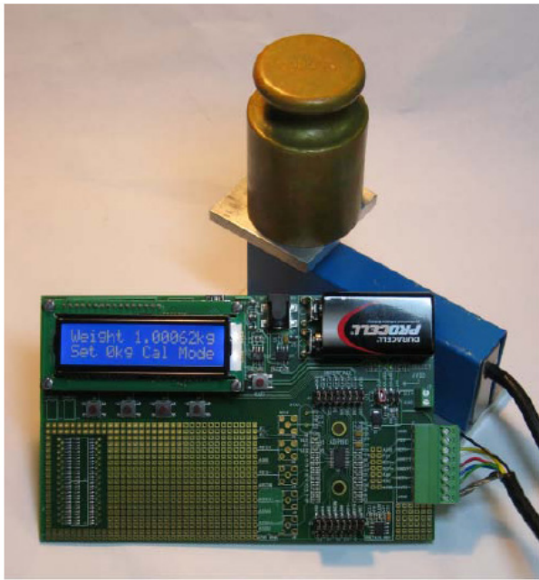
图2. 采用AD7191的电子秤系统
