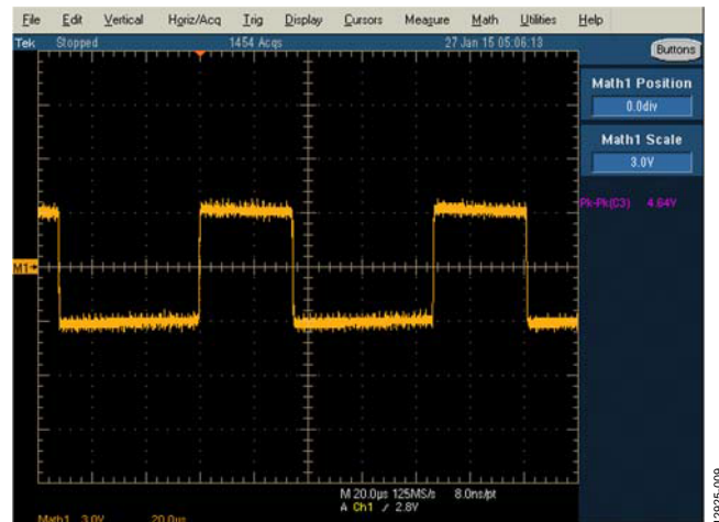
图9. EVAL-CN0373-EB1Z板上RS-485端口的Y-Z数学波形
