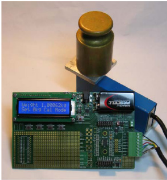
图 2. 采用 AD7192 的电子秤系统
