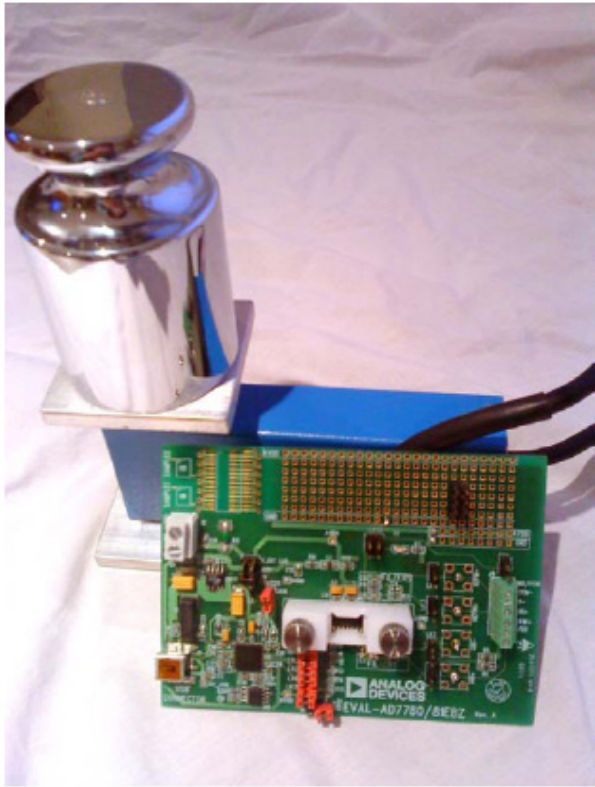
图2.采用 AD7781 的电子秤系统设置
