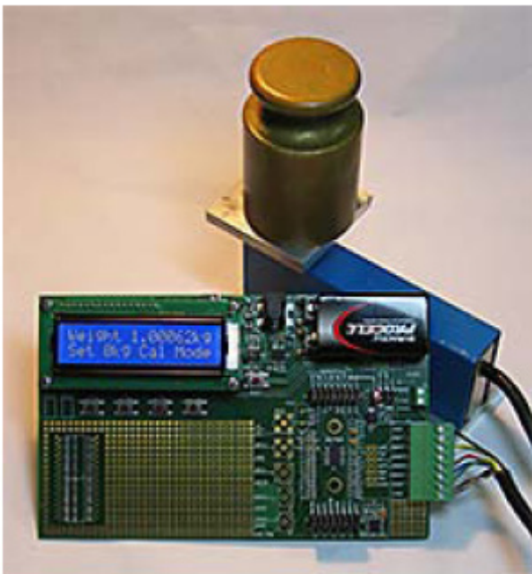
图 2. 采用 AD7190 的电子秤系统设置
