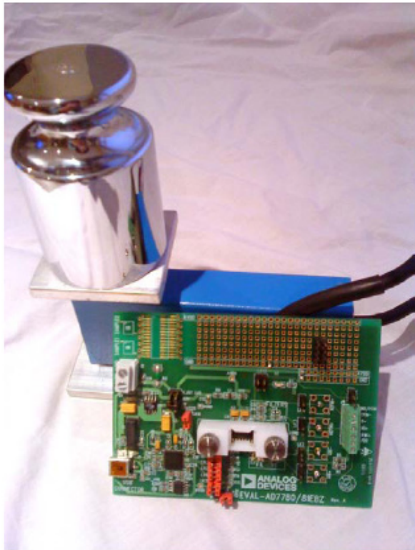
图2.采用AD7780的电子秤系统设置
