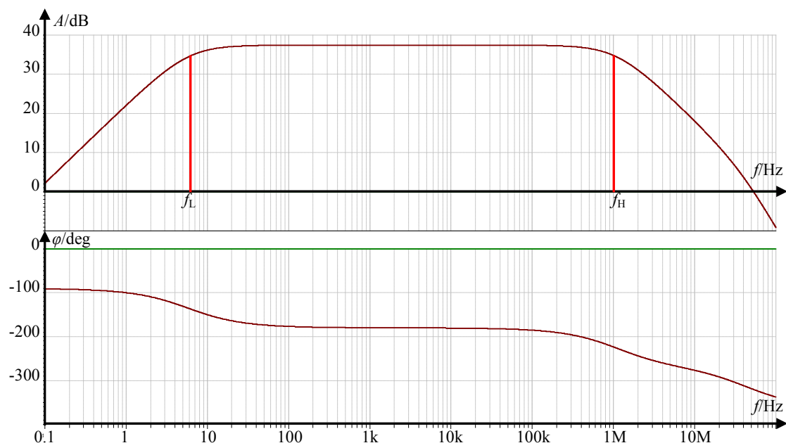
图 Section46-3 一个典型的放大电路幅频特性和相频特性
