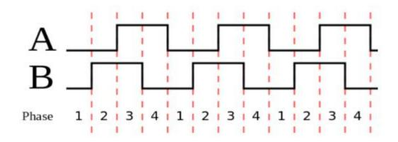
这里,我们是通过软件的方法实现四倍频。首先可以看到上图编码器输出的 AB 相波形,正常情况下我们使用 M 法测速的时候,会通过测量单位时间内 A 相 输出的脉冲数来得到速度信息。常规的方法,我们只测量 A 相(或 B 相)的上升 沿或者下降沿,也就是上图中对应的数字 1234 中的某一个,这样就只能计数 3 次。而**四倍频的方法是测量 A 相和 B 相编码器的上升沿和下降沿**。这样在同样的时间内,可以计数 12 次(3 个 1234 的循环)。这就是软件四倍频的原理。
