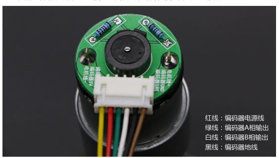
这是一款增量式输出的霍尔编码器。编码器有 AB 相输出,所以不仅可以测速,还可以辨别转向。根据上图的接线说明可以看到,我们只需给编码器电源 5V 供电,在电机转动的时候即可通过 AB 相输出方波信号。编码器自带了上拉电阻,所以无需外部上拉,可以直接连接到单片机 IO 读取。
