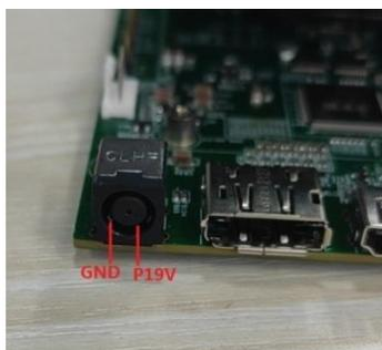
注意: 开发板连接全功率负载测试时, 请使用19V/4.7A及以上电源适配器, 全功率负载测试包括: LTP、Spec、MEMtest等。
