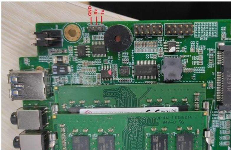
如图是CPU 3针Debug接口，支持TTL电平，波特率115200；连接顺序如图所示，如果没有输出，可以交换Tx和Rx线序。
