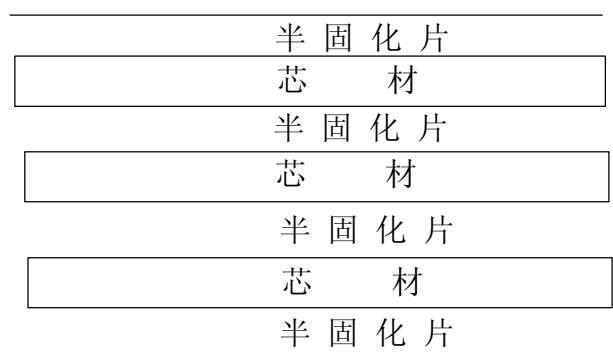
图5 芯材和板固化片的交替排部
