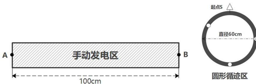
图 1 小车发电及循迹区示意图
