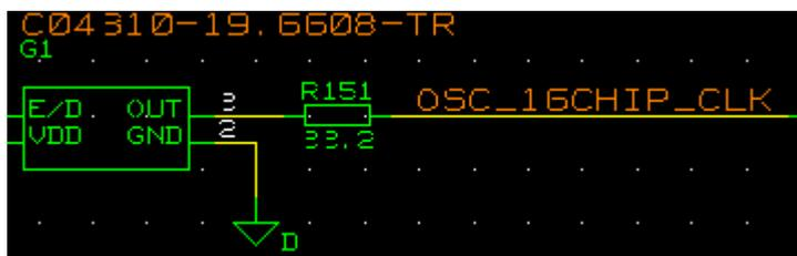
如果将串阻放在接收端，或者在串阻之前的信号进行命名，串阻之后的信号不进行命名，都会使得布线的分析和检查困难，甚至会造成串阻被放置在接收端而未被查出的结果，导致信号完整性较差。如下图是不正确的范例。
