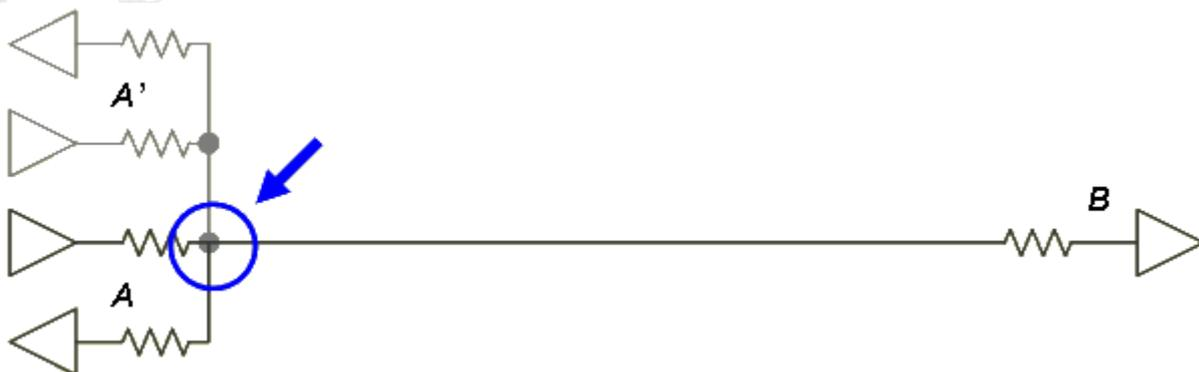
A 作为主用单板，通过一根电缆向 B 发送数据，同时和 A 和 A' 还要从背板上（标记处）收回发送出去的数据。实际应用中，A 和 A' 可能配备任何一个，也可能同时配备；B 也可能配备主备。电缆较
